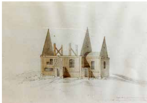
Vang z usuniętym dachem. Widoczne wewnętrzne słupy i kolebka sklepienia prezbiterium. Nie jest to przypuszczalnie etap rozbiórki, a raczej próba ukazania nietypowej konstrukcji. Akwarela F. Schiertza (RA)
